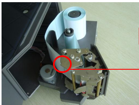
(5) 将底纸卷入收纸轴, 并调整纸带定位块使打印纸固定
