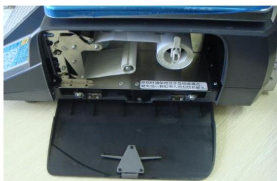
合上打印头，将打印头放回主机。
