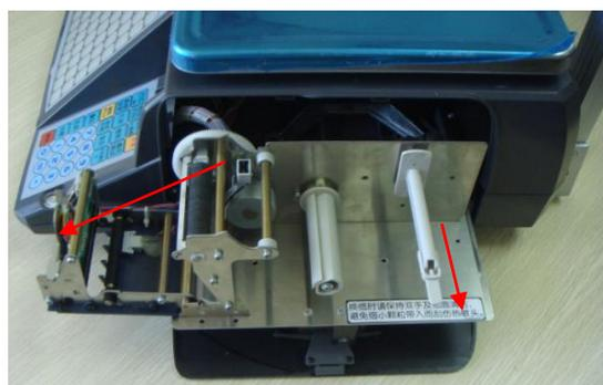
拉出打印机；打开打印头并拨平纸卷档片。
