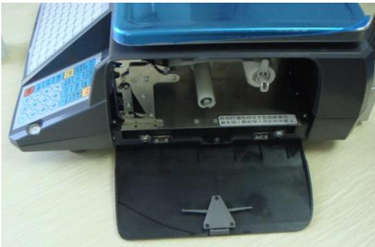
合上打印头，将打印头放回主机。
