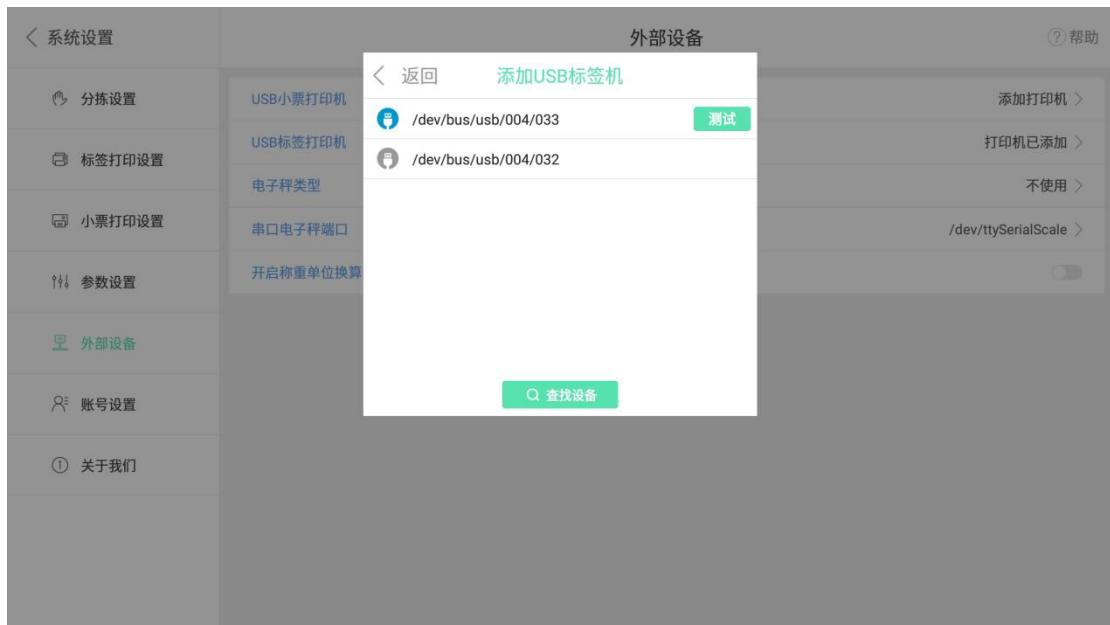
点击【查找设备】再分别点击 usb 路径后面的【测试】，查看打印机是否有打印测试纸，有打印出测试纸后，点击【返回】打印机已添加成功。
